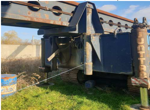
Фото 3. Бурильная установка (копёр) JUNTTAN PM-30 (HK-10), гос. рег. знак 77AC8254, 1994 года выпуска
