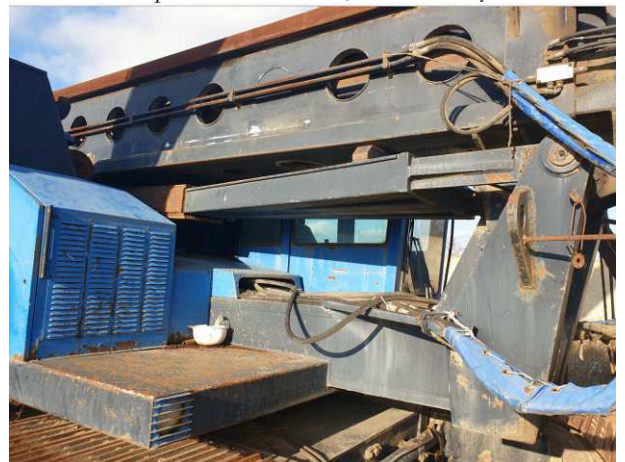
Фото 6. Бурильная установка (копёр) JUNTTAN PM-30 (HK-10), гос. рег. знак 77AC8254, 1994 года выпуска
